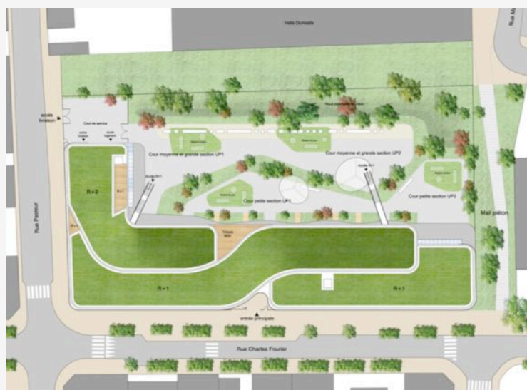
Plan de l'école maternelle terminée montrant les toits végétalisés et l'aménagement des cours de récréation.
